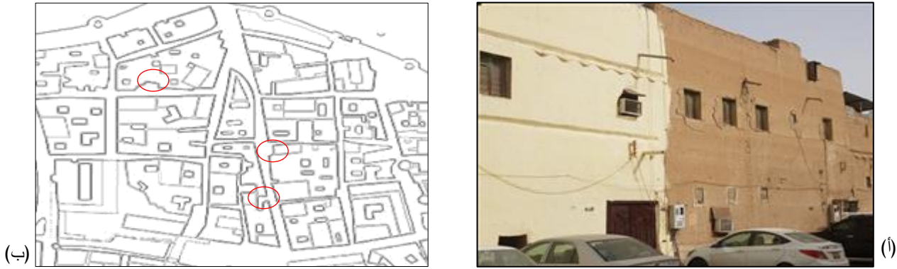
شكل ٥: (أ) انتشار الجدران المشتركة بين الجيران في الأحياء التقليدية (حي ظهيرة)، (ب). تأثير تشريع حيازة الضرر حيث ساهمت في تشكيل الفراغات الغير منتظمة الشكل في الأحياء التقليدية.
