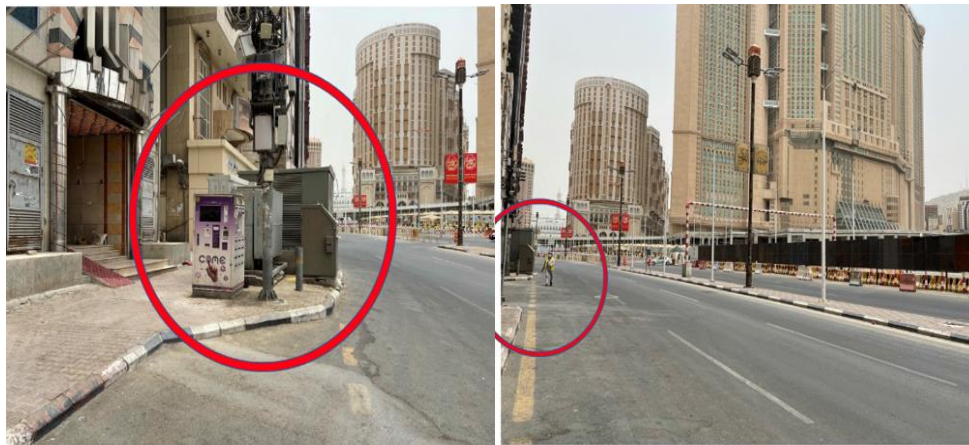
شكل ٢. التوزيع العشوائي لمحطات الكهرباء مما يعيق حركة المشاة والتداخل بين المركبات والتصادم.
